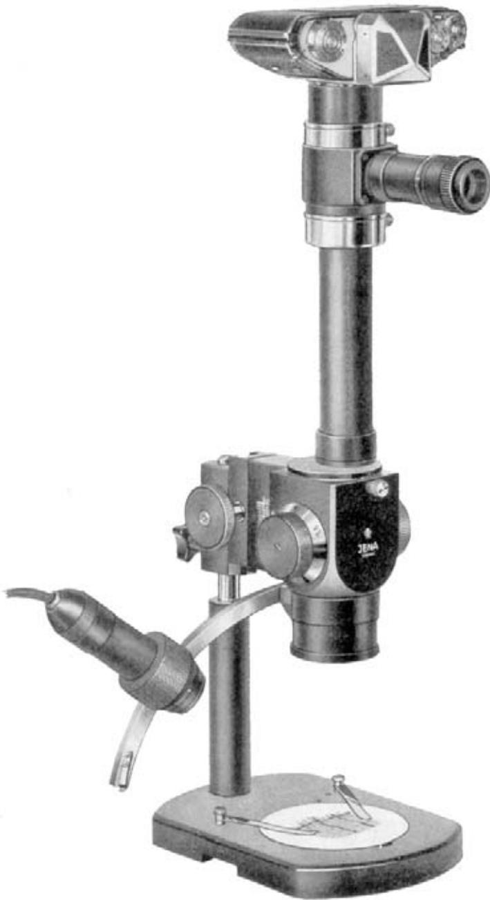
Bild 7. Stereomikroskop SM XX mit aufgesetzter Mikrophotographischer Einrichtung „MF“ und Kleinbildkamera „Exakta-Varex“
