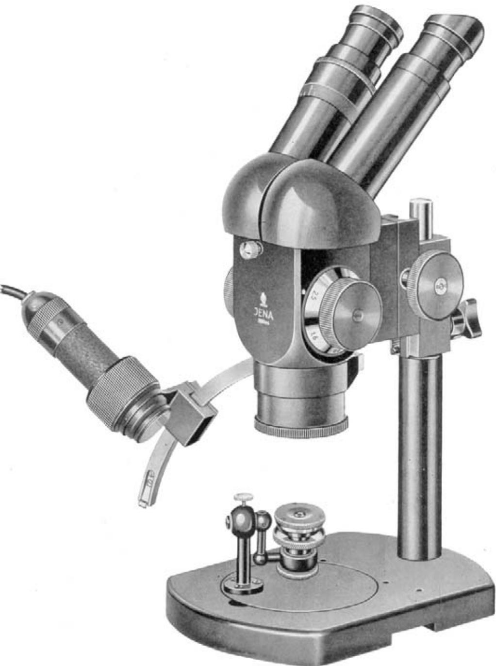
Bild 3. SM XX mit Gerät zum Prüfen von Lagersteinen
