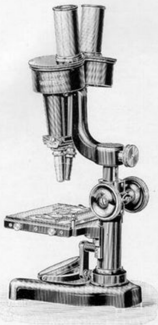
Stereoskopisches Binokular-Mikroskop nach Greenough mit abnehmbarem Oberteil.
